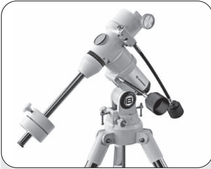
Abb. 7: Befestigung des Gegengewichts an der Gegengewichtsstange.
