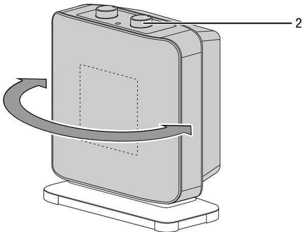
2. Stellen Sie den Funktionsschalter (2) auf die Position **I** bzw. **II**, um die Oszillation wieder auszuschalten.
