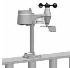
A. Montage an einem Geländer.
