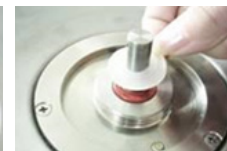
2. Retirer le joint supérieur
