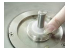
5. Préparer un nouvel anneau – Le déplier conformément
