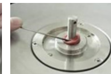
3. Retirer le joint inférieur
