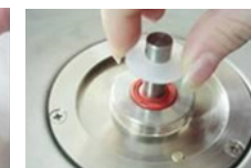
8. Placer le joint supérieur
