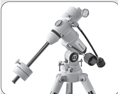
Abb. 2f: Anbringen der Prismenschiene am Schaft der Montierung (EXOS-1)
