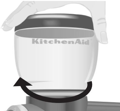
2. Setzen Sie den Kaffeemehlbehälter auf die Behälterplattform. Der Behälterdeckel wird hierbei am Motorgehäuse leicht eingedrückt und sichert den Behälter in seiner Lage. Der Behälter muss in der Mitte der Plattform stehen.
