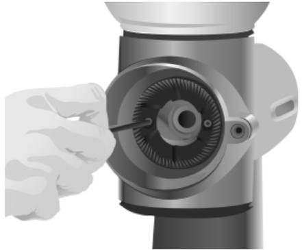
4. Schrauben Sie mit den Befestigungsschrauben die Ersatzstifte an die Welle und an das Motorgehäuse an. Hierbei müssen die Schneiden der Stifte nach außen zeigen und die Schrauben fest angezogen werden.
