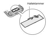
2. Legen Sie die Batterien so ein, dass die Polarität den Markierungen im Batteriefach entsprechen.
