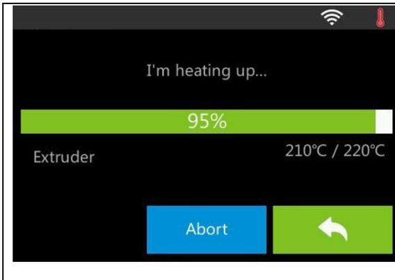
Auf dem Bild wird das Menü für das Aufwärmen dargestellt. Es werden die aktuelle Temperatur sowie die Zieltemperatur angezeigt. Tippen Sie auf die Schaltfläche [Abort], um den Aufwärmvorgang abubrechen.
