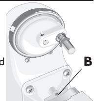
**N.B.:** De platte garde mag, bij een juiste instelling, de bodem of de zijkant van de kom niet raken. Als de platte garde of draadgarde zo dichtbij de kom is afgesteld dat deze de bodem raakt, kan de deklaag van de platte garde of het materiaal van de draadgarde slijten. Het leegspatelen van de kom kan soms nodig zijn, ongeacht de instelling van de garde. De mixer dient dan te worden afgезet om schade aan de mixer te voorkomen.
